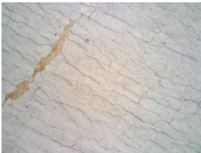
Praskliny v zušlechťující vrstvě, zvětšeno 50x
