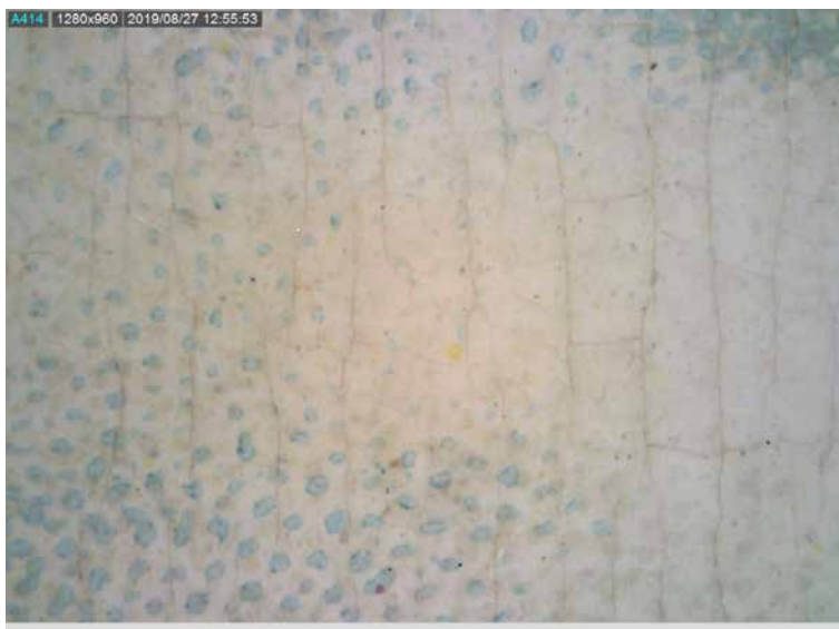
Praskliny v zušlechťující vrstvě, zvětšeno 50x
