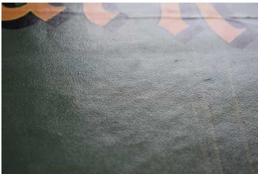
Lakovaný povrch plakátu – „hrudkovitý“ povrch
